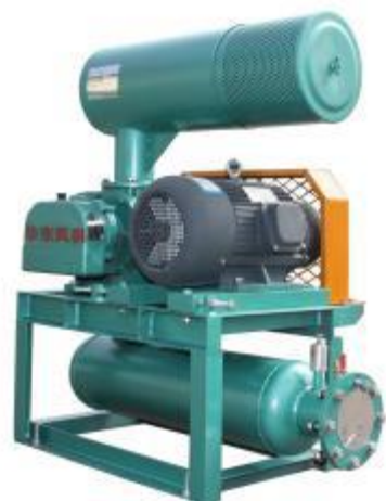
трехлопастные воздуховки Рутса типа серии HDSR перепад давления:0.098-16бар производительность:0.67-198.1m 3 /мин
