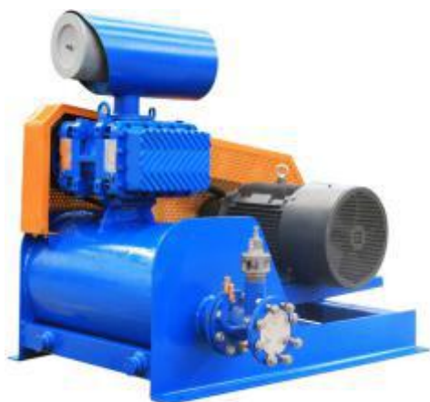
воздуховка Рутс типа серии HG перепад давления:0.098-16бар производительность:0.6-115m 3 /мин
